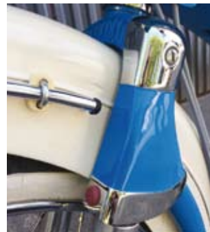
Pressade plåtkåpor döljer stötdämparinfästningen på framgaffeln.
