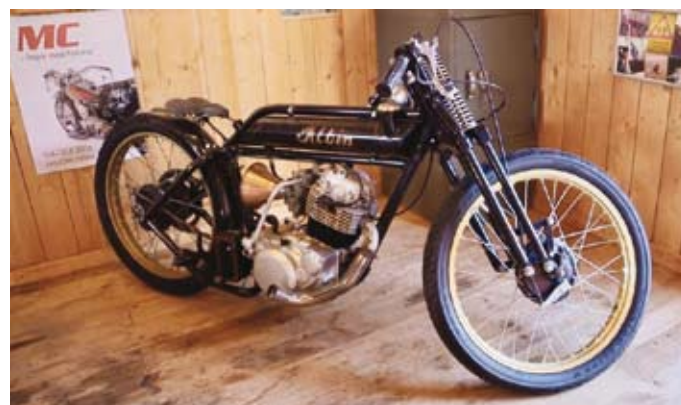
Ingemar blev intresserad av board-track-stilen och byggde sig en kopia som fick namnet "Albin". Motorn är en Yamaha 250, ram och framgaffeln tillverkades av vattenledningsrör. Resultatet blev strålande!
